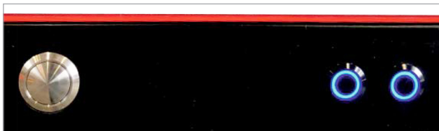
Abb. 4.1 Entriegelungstaster (links) und blau leuchtende Be- und Entladetaste (Entladen - links / Beladen - rechts)
