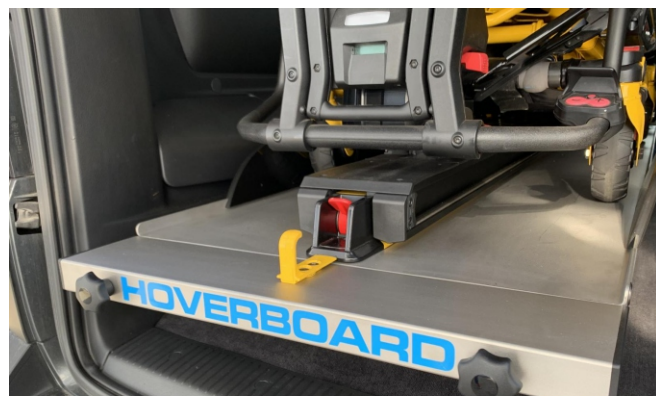
NOTBETRIEB Plattenverlängerung ist montiert
